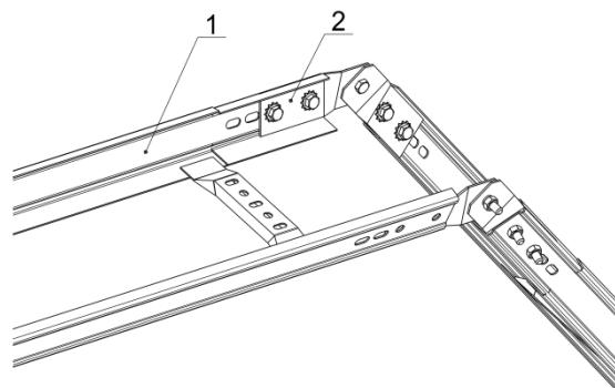
Применение прижима при монтаже лотка к полке кабельной
