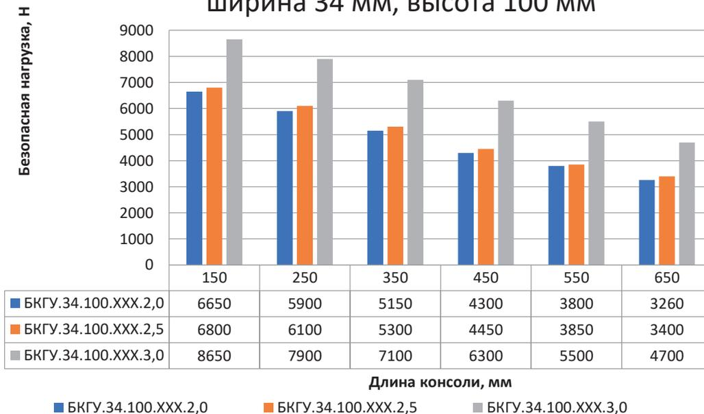
\*Нагрузка консолей БКГС и БКГУ дана при условии, что толщина профиля на один размер больше толщины консоли. Например: нагрузка 7900 Н консоли БКГУ.34.100.250.3,0 толщиной 3 мм соответствует при применении профиля БПП.40.40.XXX.4 с толщиной 4 мм
