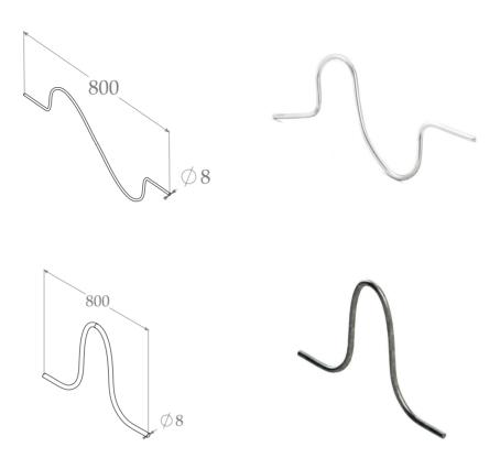
Компенсационные соединители предназначены для компенсации температурного и прочего перемещений в цепи молниезащиты
