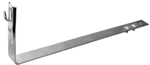
**Держатели черепичные предназначены для монтажа проводника на черепичной, шиферной и мягкой кровле. Высота крепления проводника составляет 100 мм.**
